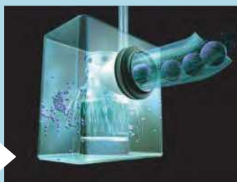
排水と同時に内蔵カッターが固形物を粉碎します。
